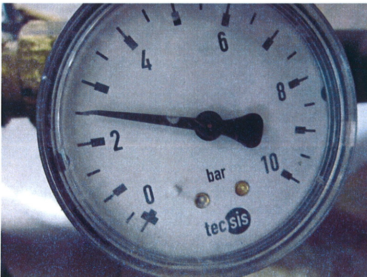
Abbildung 5: Druckdichtigkeitsprüfung mit Wasser gefüllter Druckglocke mit einem Nenndruck von 2,5 bar (oben: Manometerstand bei Versuchsbeginn am 28.03.2011 um 8:00 Uhr; unten: Manometerstand nach Versuchsende am 31.03.2010 um 8:45 Uhr)
