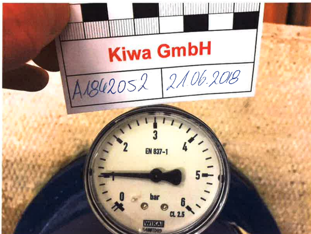
Abbildung A2. Druckdichtigkeitsprüfung der mit wassergefüllten Druckglocke bei einem Nenndruck von \geq 1 bar (Manometerstand nach 24 Stunden am 21.06.2018).
