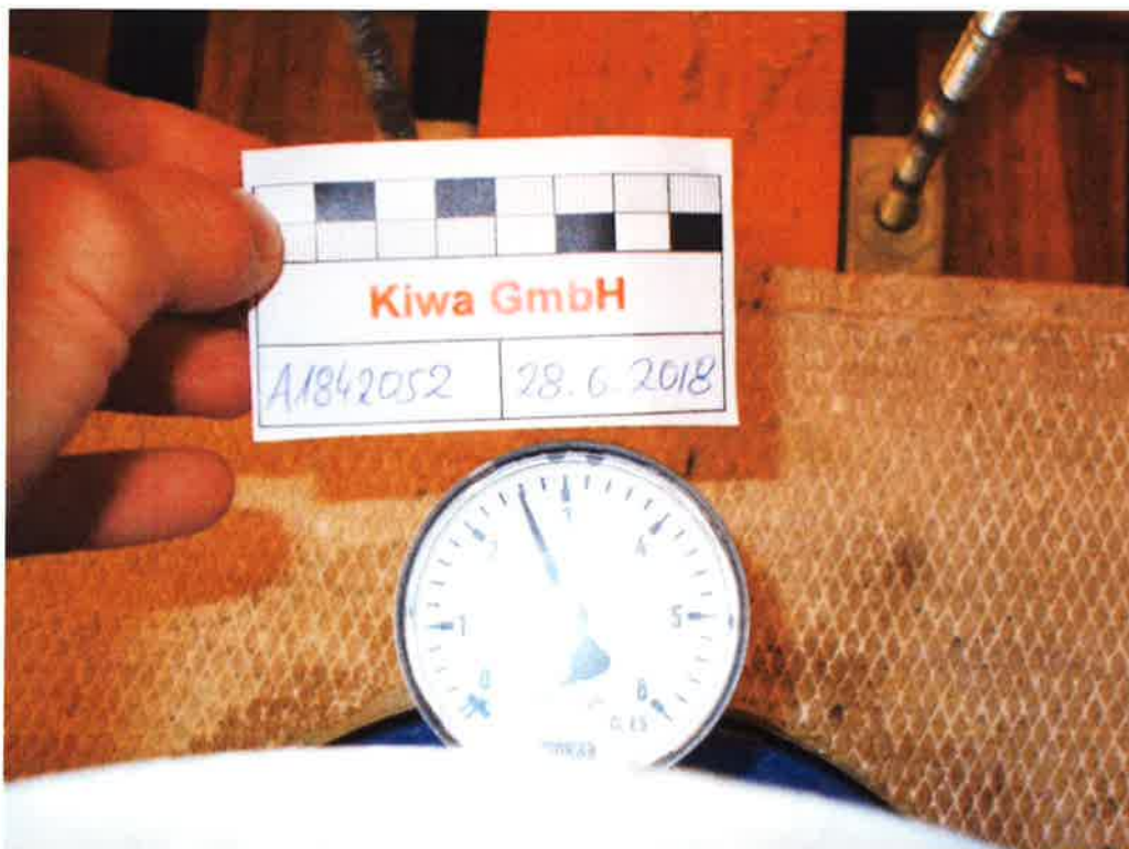
Abbildung A8. Druckdichtigkeitsprüfung der mit wassergefüllten Druckglocke bei einem Nenndruck von \geq 2,5 bar (Manometerstand nach 72 Stunden am 28.06.2018).
