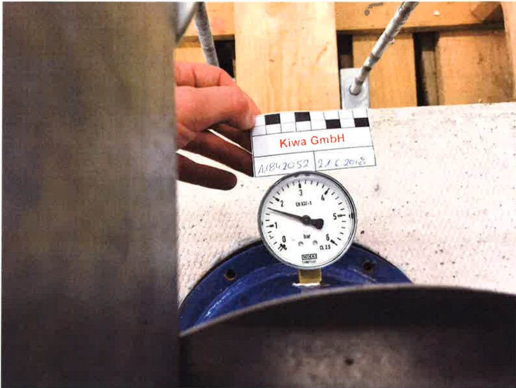
Abbildung A3. Druckdichtigkeitsprüfung der mit wassergefüllten Druckglocke bei einem Nenndruck von \geq 1,5 bar (Manometerstand bei Versuchsbeginn am 21.06.2018).
