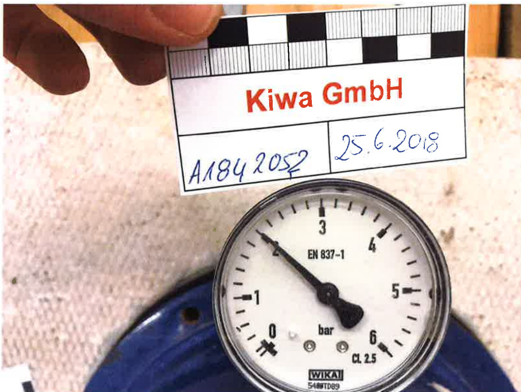
Abbildung A6. Druckdichtigkeitsprüfung der mit wassergefüllten Druckglocke bei einem Nenndruck von \geq 2,0 bar (Manometerstand nach 67 Stunden am 25.06.2018).
