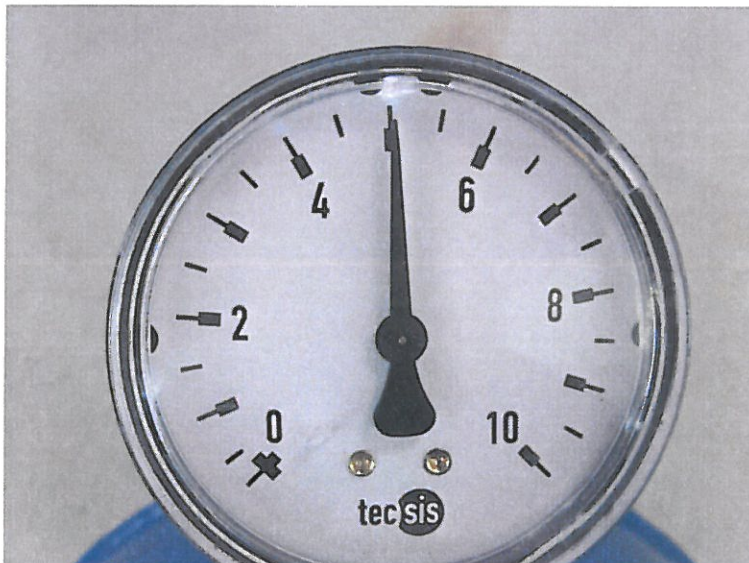
Abbildung 4: Druckdichtigkeitsprüfung mit Druckluft gefüllter Druckglocke (5 bar) bei 23 °C (oben: Manometerstand bei Versuchsbeginn am 18.04.2011 um 07:45 Uhr; unten: Manometerstand nach Versuchsende am 19.04.2011 um 10:10 Uhr)
