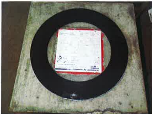
Abbildung 3. Versuchskörper vor Installation der Druckglocke.
