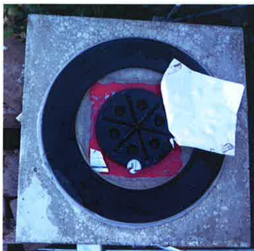
Abbildung 7. Versuchskörper nach Abnahme der Druckplatte und der Schutzfolie.
