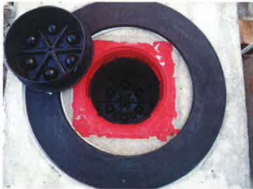
Abbildung 8. Versuchskörper nach Abnahme der Druckplatte und nach Entfernen des Verschlussdeckels.
