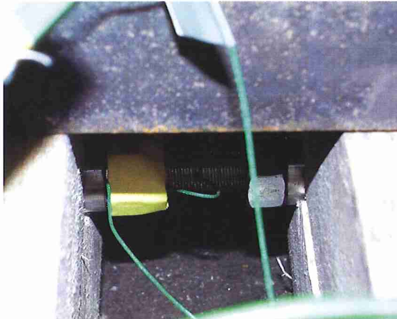
Bild 5: Temperaturmessstelle in Durchführungsmitte (Messstelle T2)
