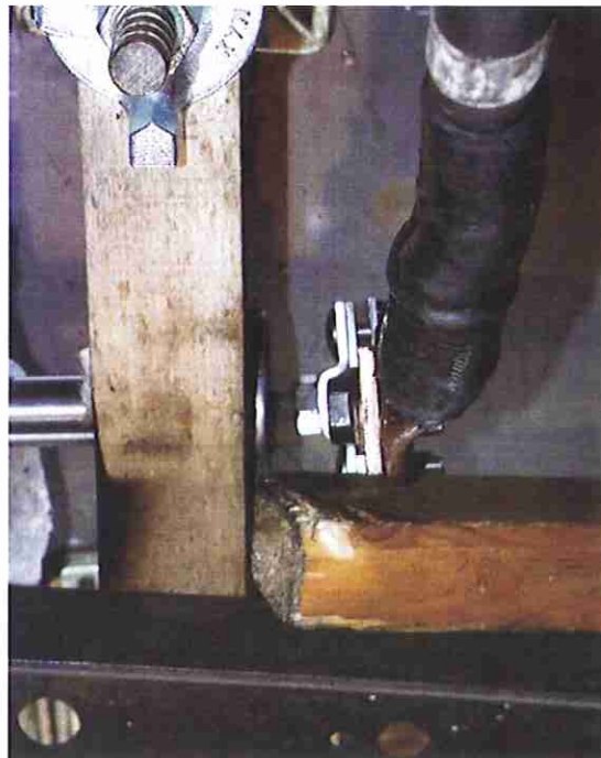
Bild 28: Rechter Anschluss nach Versuch 122-02/113 mit Temperturmessstelle T2
