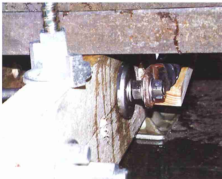
Bild 18: Rechter Anschluss des Prüflings 2 nach Versuch 122-02/110
