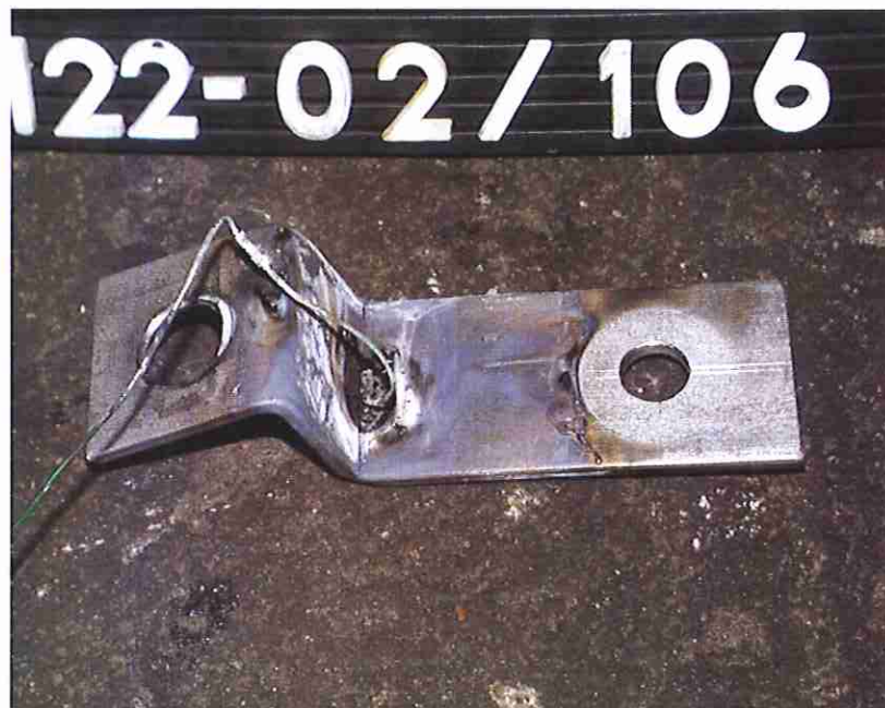
Bild 4: Linker Anschluss (Edelstahl-Lasche) mit Temperaturmessstelle (Stelle T1) nach Versuch 122-02/106
