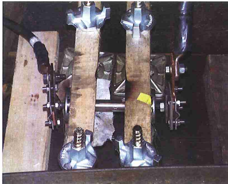
Bild 29: Prüfaufbau mit Prüfling 4 vor Versuch 122-02/114 (Temperaturmessstelle T1 links im Edelstahlbolzen und Messung T2 rechts im Edelstahlbolzen)
