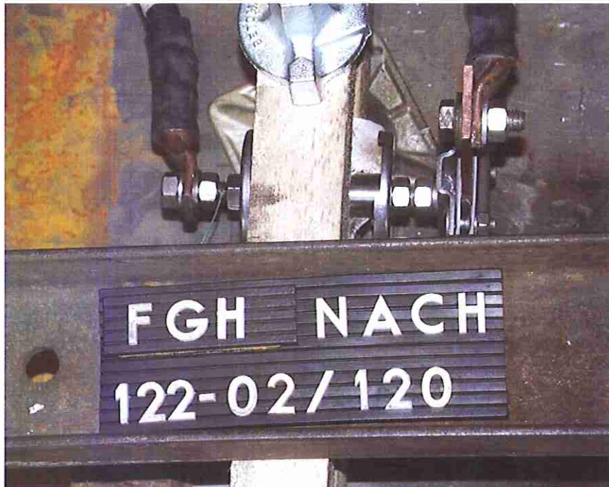
Bild 42: Prüfaufbau mit Prüfling 7 nach Versuch 122-02/120 (Temperaturmessung T1 im linken Gewindebolzen)
