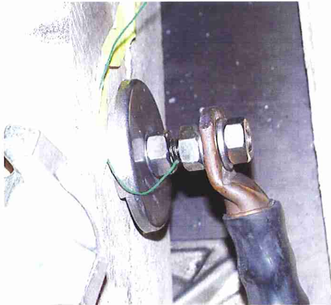
Bild 35: Linker Prüflingsanschluss mit Temperaturmessstelle T1 im Edelstahlgewindebolzen nach Versuch 122-02/117 (von der Rückseite gesehen)
