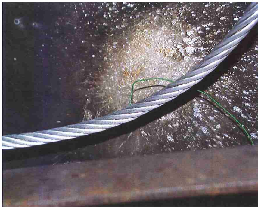
Bild 40: Temperaturmessstelle T2 vor Versuch 122-02/118
