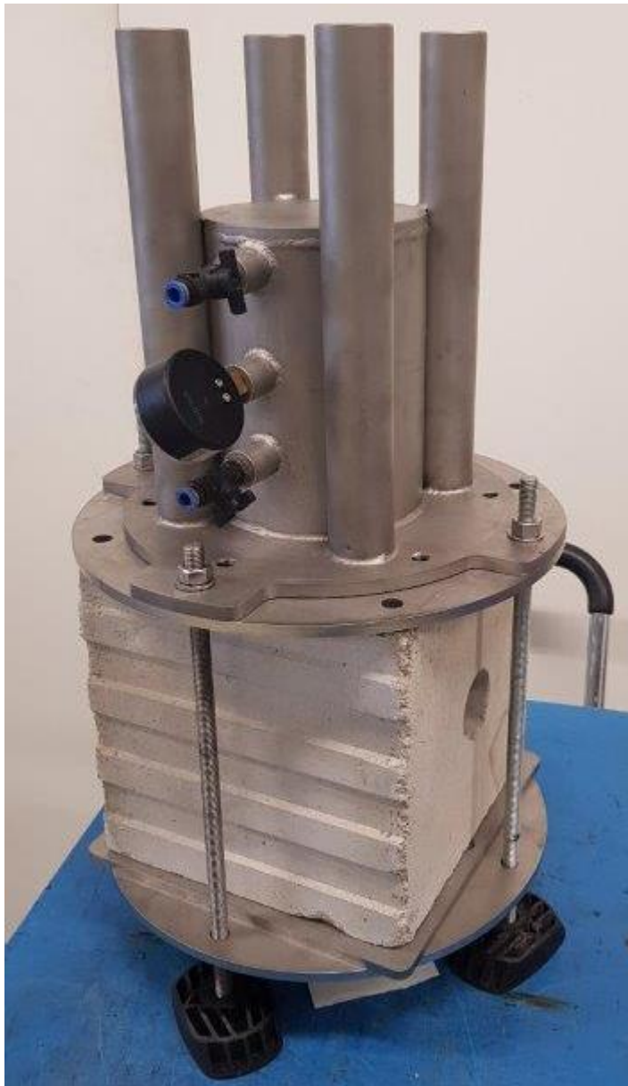
Abbildung 1. Versuchsaufbau – Gesamtsystem - PMBC beschichteter Prüfstein.
