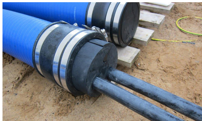
KES150 MA WE160 SG SET 密封套既可以用作盲盖，也可用于密封螺旋软管。通过分段圆环技术可以现场调整相应的电缆直径。
