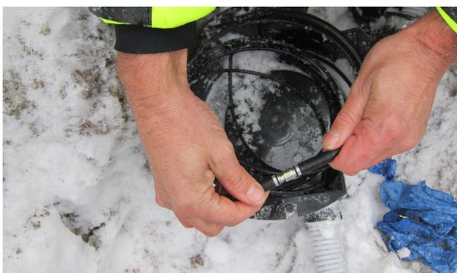
Das Kabelsystem Hauff-Quick-Connect wird über einen Stecker in der Überlängenbox verbunden. Die Kabel sind in den Längen 10 m, 20 m oder 30 m erhältlich. Die Kabelüberlänge wird in der Überlängenbox abgelegt.
